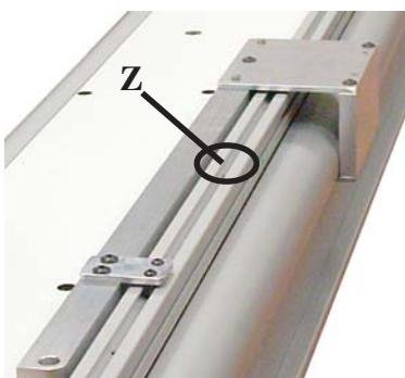
Desbloquear el tornillo de bloqueo Z y deslizar la guía GB del TD en los tornillos 1-2-3 de la mesa de la derecha y la tuerca de los 2 soportes de regla R1 y R2. El tornillo 3 debe ser visible en el orificio T3. Apretar los tornillos 1, 2, 3 y V1 y V2 de los soportes de regla R1 y R2 con una llave Allen de 4 mm.
