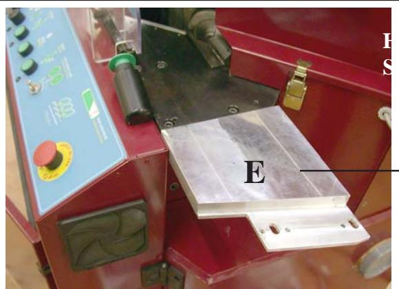
Extraer el TD de su caja e invertirlo. Llevar el asiento del TD sobre la escuadra E y atornillar el conjunto (llave de pipa de 10 mm prolongada + llave Allen de 5 mm) sin apretar, con los 2 tornillos, las 2 arandelas y las 2 tuercas incluidas.
