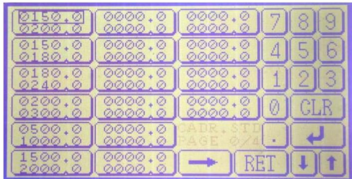
Hay 5 páginas de 16 marcos típicos. Todas las dimensiones se pueden reparametrar con el bloque numérico. La ejecución de un marco se realiza pulsando su tecla: entonces, se pasa a la pantalla de ejecución cambiando únicamente los valores de longitud y anchura del marco tipo. De este modo, se pueden combinar los marcos tipo con la toma de medida SMART STOP o un artículo en memoria.
