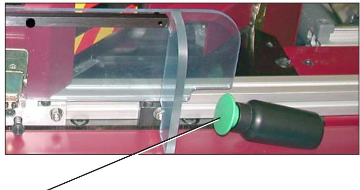
Con la SMART STOP, si se pulsa el **botón del medidor** aparece el mensaje de alarma:
