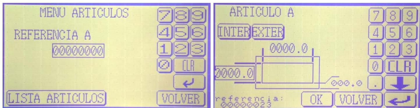
Pulsar la tecla validación . Aparece el mensaje 'ESPERE, POR FAVOR' aproximadamente medio segundo y, después, la pantalla de los datos artículo. Se pueden modificar todos los valores con el bloque numérico. Los valores introducidos deben validarse inmediatamente con la tecla . Para pasar de un valor a otro, pulsar la tecla .
